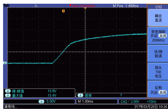
图 6. 18V 输入满载启动波形
